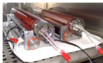
Protéza endotelizována v dynamickém kultivačním systému, implantována minipraseti (IKEM, dr. Jaroslav Chlupáč)
